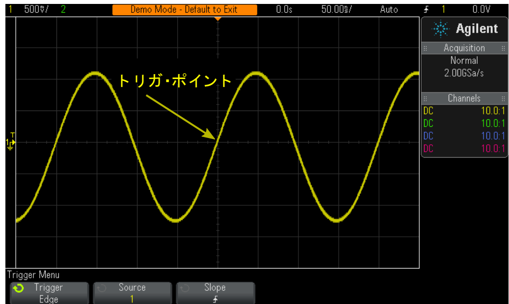
図12 チャンネル1の立ち上がりエッジ (0.0 V) でのオシロスコープのトリガ
