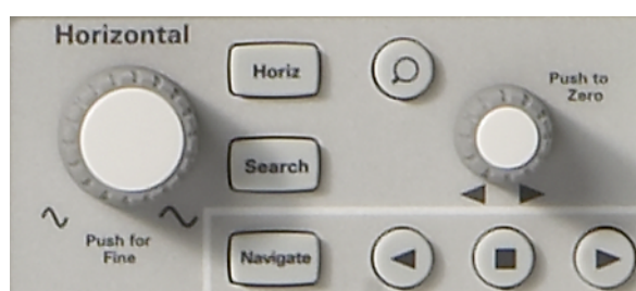
図4 オシロスコープの水平軸 (X軸) コントロール
