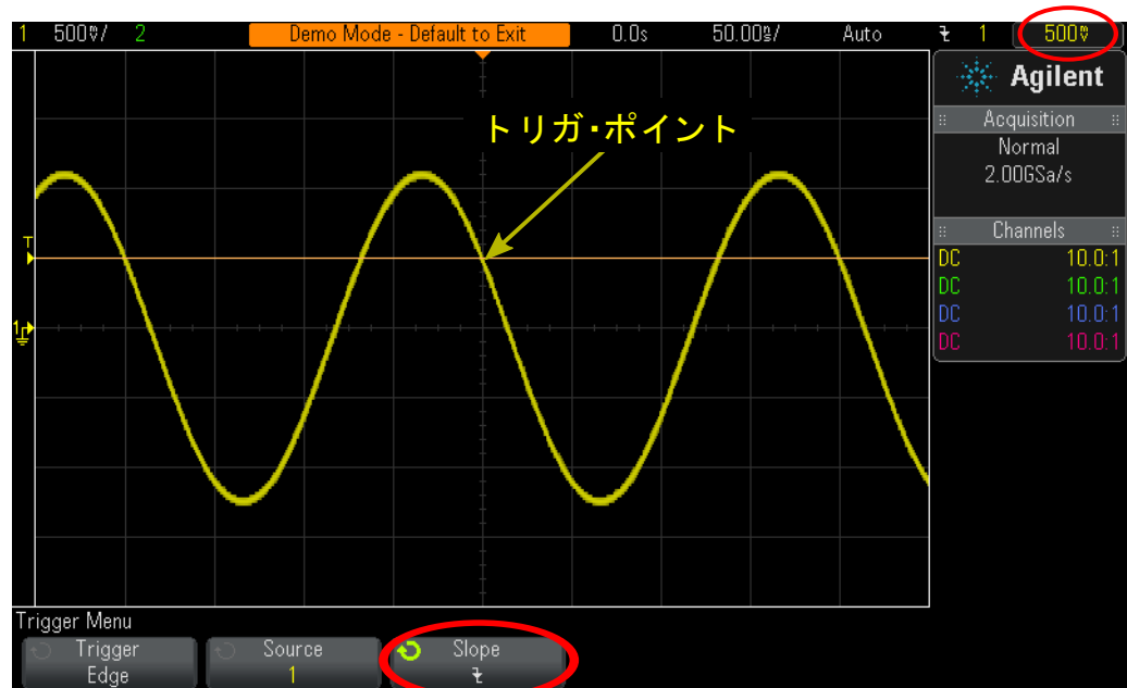
図13 正弦波の立ち下がりエッジ（+500 mV）でのトリガ
