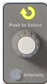
図7 オシロスコープの汎用入力コントロール
