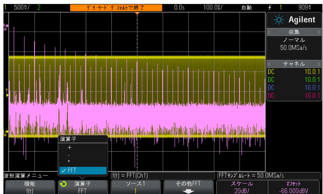
図43 繰り返しデジタル・クロックに対するFFT演算機能の実行
