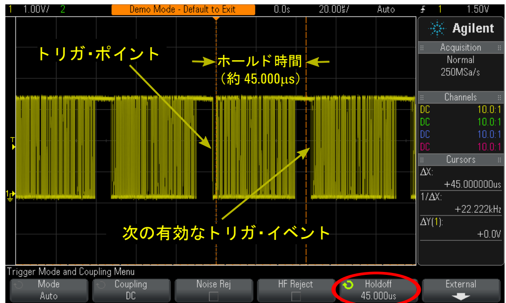
図27 オシロスコープのトリガ・ホールドオフ機能を使用したバースト・パルスでの同期
